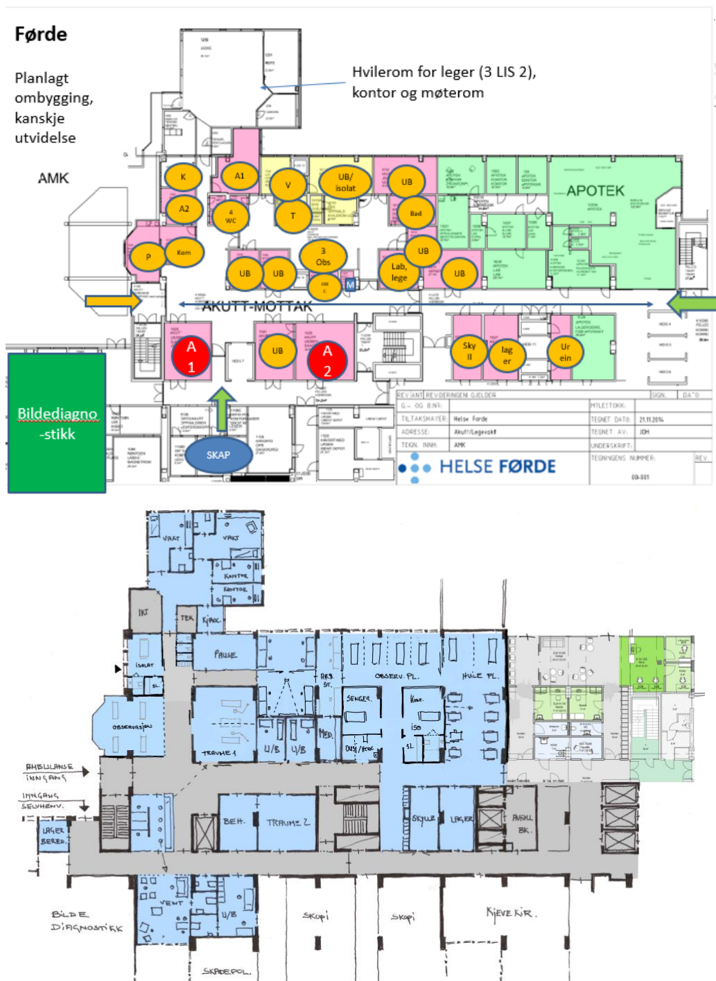
Figur 9 Akuttmottaket med pasientflyt Førde - akuttmottak med type rom per 2019 og forslag til ny planløsning for akuttmottak med ferdigstillelse 2022/2023
