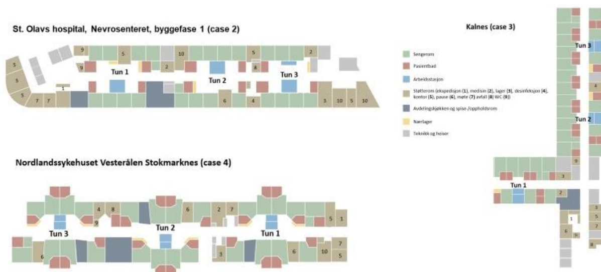
Figur 6.19 Sengetun. Eksempler fra tre sykehus. St. Olavs Hospital (Nevrosenteret), Sykehuset Østfold Kalnes og NLSH Vesterålen. Sykehusbygg HF. Presentasjon NSF webinar 03.02.2021
