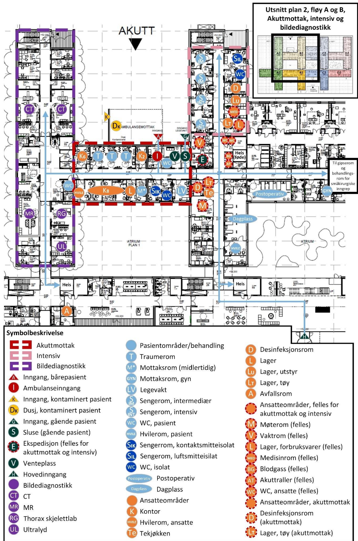
Figur 5.2 Illustrasjon av akuttmottaket i Kirkenes sykehus. Plan 2. Kilde: Momentum arkitekter, tilrettelagt av Sykehusbygg HF
