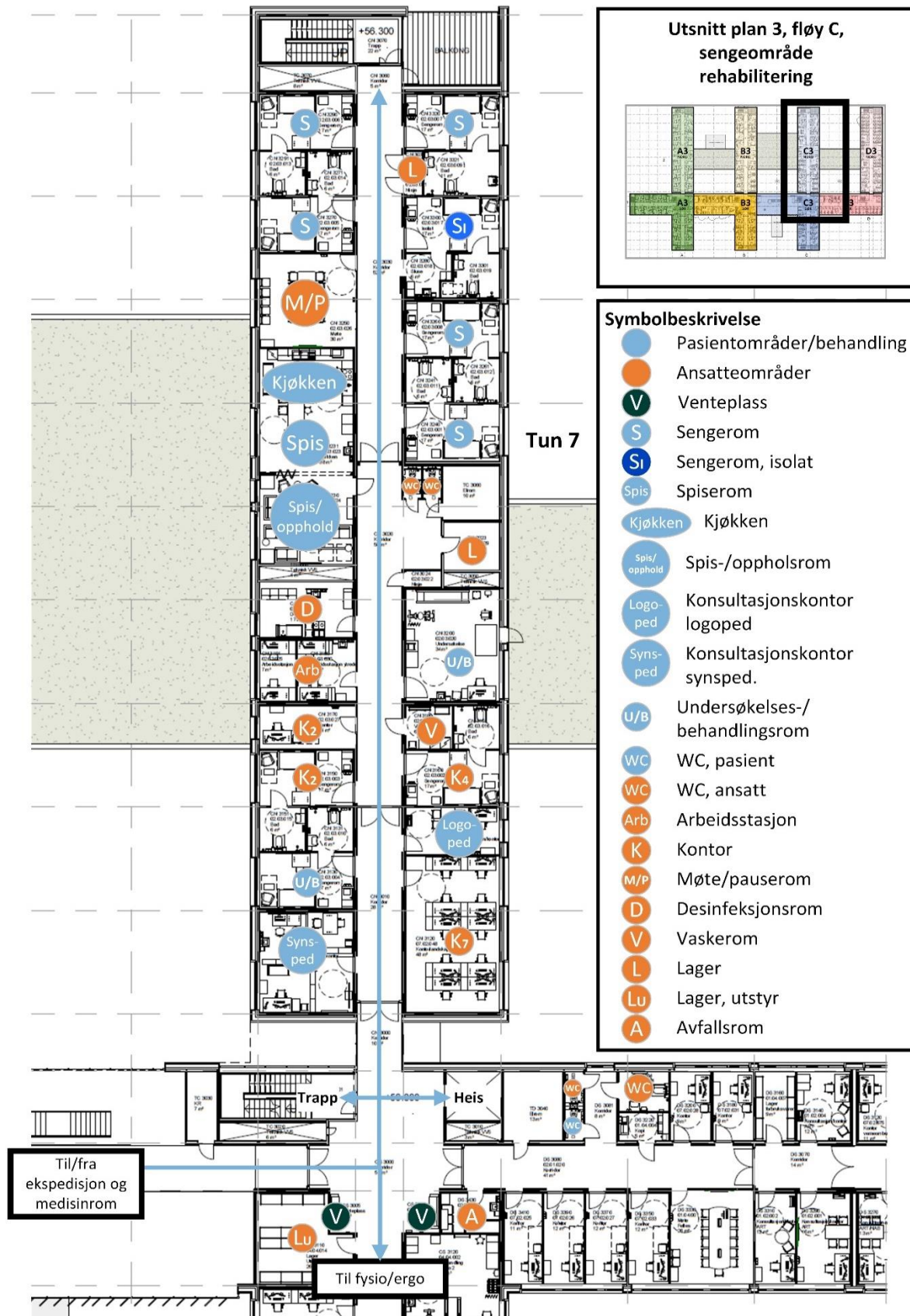
Figur 6.18 Illustrasjon for pasientflyt i sengeområde for Fysisk medisin og rehabilitering (FMR), samt sengerom, undersøkelses- og behandlingsrom og støtterom. Tun 7. Kilde: Momentum arkitekter, tilrettelagt av Sykehusbygg HF
